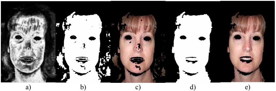
Figura 4 – Segmentação de uma face numa imagem baseada na detecção de pele: imagem de probabilidade (a); imagem binária representativa dos segmentos identificados como pele (b); imagem original representativa dos segmentos identificados (c); segmento da imagem binária filtrado e identificado como potencial face (d); e segmento da imagem original filtrado e identificado como potencial face (e).
