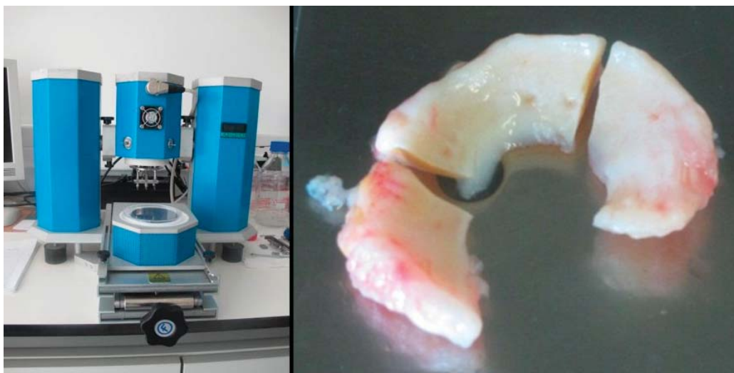
Figura 5. Fotografia do equipamento de caracterização mecânica dinâmica (DMA, esquerda) e segmentação do menisco humano (direita).
