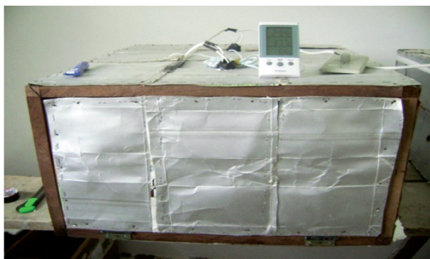
Figura 1 – Protótipo de incubadora recoberto com embalagem laminada.
