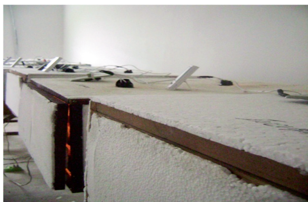
Figura 2 – Protótipo de incubadora recoberto com isopor.
