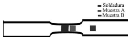
Fig. 16. Esquema de la extracción de muestras con el objetivo de comprobar si existe modificación de la microestructura durante los ensayos de fluencia lenta.
