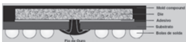
Fig. 1. Secção transversal de uma memória DRAM, identificação dos materiais [2].
