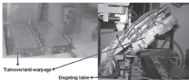
Fig. 28. Sistema de anti-warpage existente no processo de Mold .
