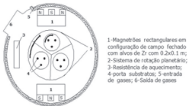
Fig. 1- Representação esquemática da câmara de deposição utilizada.
