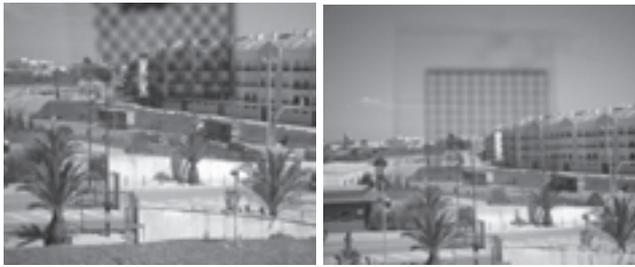
**Fig. 8.** Fotografias da vista exterior de uma habitação, através de células solares semi-transparentes produzidas, coladas no vidro da janela.
