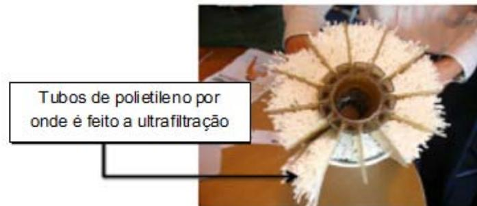
Fig. 1 - Fotografia interna de um cartucho de membrana.
