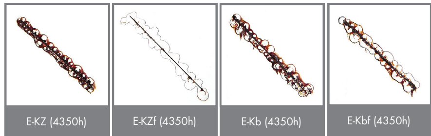
Fig. 9 - Aspecto dos provetes, na região da incisão, revestidos com os esquemas de tintas em pó, após o ensaio cíclico de corrosão.
