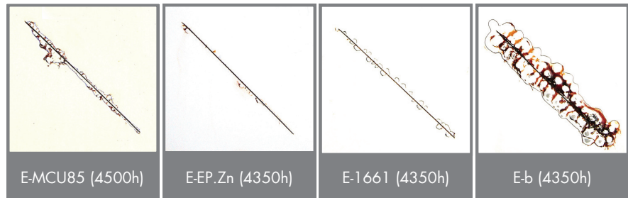
Fig. 10 - Aspecto dos provetes, na região da incisão, revestidos com os esquemas de tintas líquidas, após o ensaio cíclico de corrosão.
