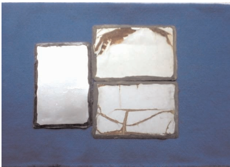
Fig. 1 – Esquema con pintura de fondo alkídica, con protección por barrera y acabado alkídico. A la izquierda probeta patrón, arriba derecha probeta expuesta en Santa Cruz y abajo derecha probeta expuesta en La Paz. A los tres años de exposición se observa una fisuración y exfoliación muy intensas, que se presentaron desde el primer año de exposición.
